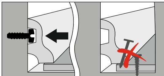
7.14 Плинтус крепится к стене. Следите за тем, чтобы плинтус не был жёстко закреплён на поверхности кварцевого паркета и обеспечивал подвижность, не фиксируя напольное покрытие.
