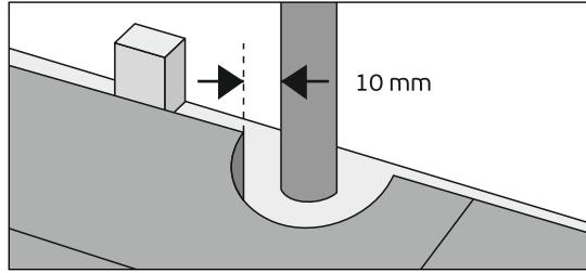
7.12 Возможно, придётся обрезать последний ряд - для более качественной укладки измеряйте ширину элемента с двух сторон, учитывая деформационный зазор 10 мм.
