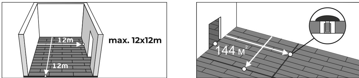
7.18 Площадь максимально возможной бесспороговой укладки до 144 м<sup>2</sup> при условии, что максимальная длина и ширина беспрерывного ряда должна составлять не более 12 м. При отсутствии разрывов в укладке кварцевого паркета в дверных проемах общая длина или ширина – это сумма длин или ширин всех комнат.
