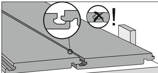
7.6 Плашки следующего ряда соединяются сначала по короткой стороне. После этого их нужно соединять по длинной стороне с предыдущим рядом.
